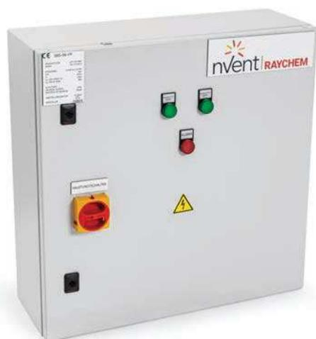
La gamme d'armoires de contrôle nVent RAYCHEM SBS offre une solution complète pour les câbles chauffants autorégulants nVent RAYCHEM pour la protection contre le gel des tuyaux et le maintien de la température. Cette armoire offre un contrôle avec sonde de température sur tuyauterie et / ou une option ambiante PASC (Proportional Ambient Sensing Control).
