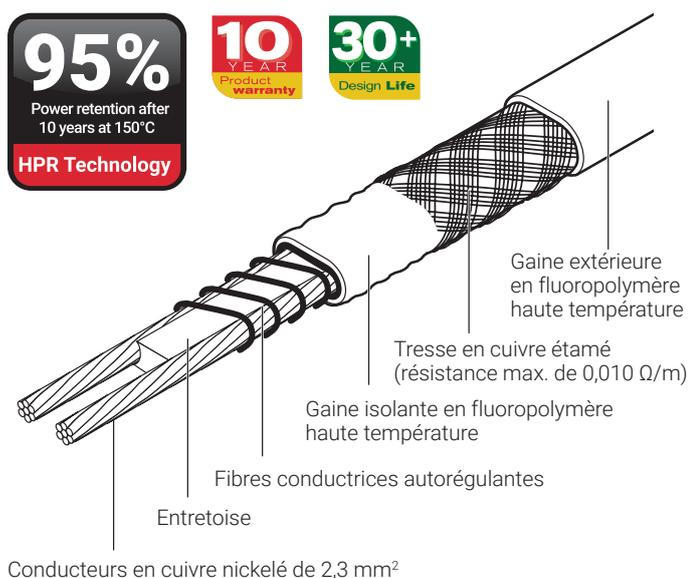
Le ruban chauffant autorégulant nVent RAYCHEM XTVR est conçu pour la protection contre le gel ou le maintien de la température de process. des tuyaux et des cuves nécessitant une puissance élevée et des températures d'exposition élevées.
