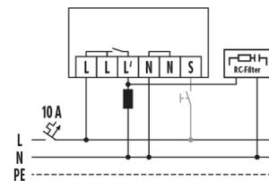
Installation standard avec commande optionnelle par poussoir et raccordement en parallèle de 8 appareils au maximum
