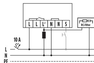
Raccordement d'inductances (par ex. relais, contacteur, ballast) peut nécessiter l'insertion d'un filtre RC (RC-Filter).
