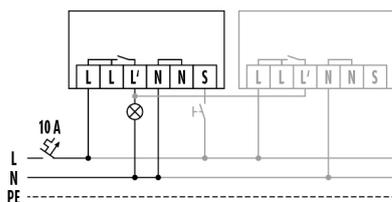
Installation standard avec commande optionnelle par poussoir et raccordement en parallèle de 8 appareils au maximum
