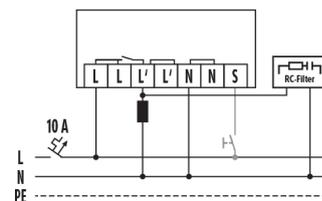
Installation standard avec commande en optionnelle par poussoir et raccordement en parallèle de 8 appareils au maximum
