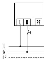
Raccordement standard avec interrupteur
