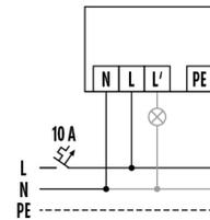
Raccordement standard avec raccordement optionnel de luminaires externes
