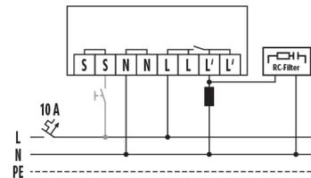
Raccordement d'inductances (par ex. relais, contacteur, ballast) peut nécessiter l'insertion d'un filtre RC (RC-Filter).
