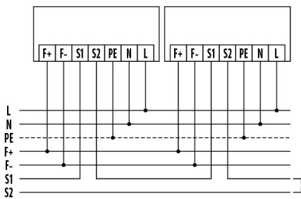
Raccordement en série avec d'autres luminaires de secours
