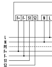
Raccordement avec contact de dysfonctionnement (S1/S2) et coupure à distance (F+/F-)
