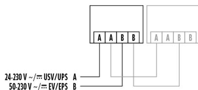
Raccordement standard (optionnel en série avec d'autres luminaires de secours)
