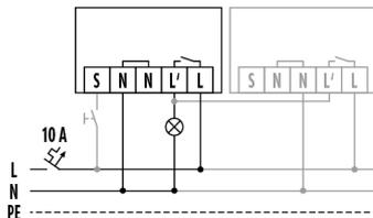
Raccordement avec commande optionnelle par poussoir. Mise en parallèle de 10 appareils au maximum.
