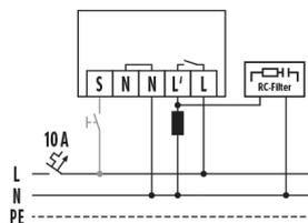
Raccordement d'inductances (par ex. relais, contacteur, ballast) peut nécessiter l'insertion d'un filtre RC (RC-Filter).
