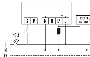
Raccordement d'inductances (par ex. relais, contacteur, ballast) peut nécessiter l'insertion d'un filtre RC (RC-Filter).
