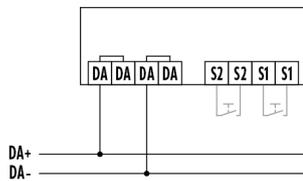
Raccordement avec commande optionnelle par poussoirs. Longueur de câble entre le poussoir et le détecteur : 30 m maximum
