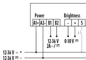
Raccordement avec commande optionnelle par poussoir.
