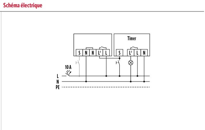
Raccordement sur minuterie et commande optionnelle par poussoir
