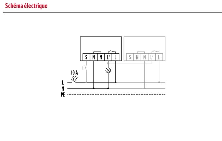
Raccordement avec commande optionnelle par poussoir. Mise en parallèle de 10 appareils au maximum.
