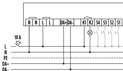
Raccordement avec commande optionnelle par poussoirs.
