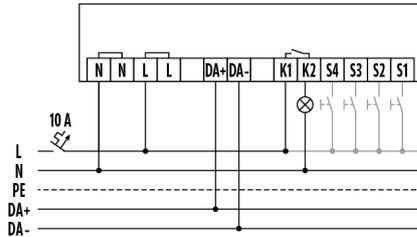
Raccordement avec commande optionnelle par pushboirs.
