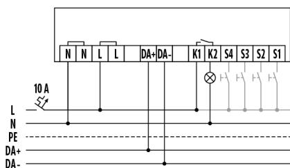
Raccordement avec commande optionnelle par poussoirs.
