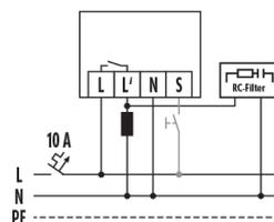
Installation standard avec commande optionnelle par poussoir et raccordement en parallèle de 8 appareils au maximum
