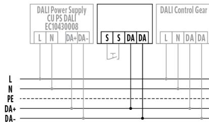
Raccordement avec commande optionnelle par poussoir.
