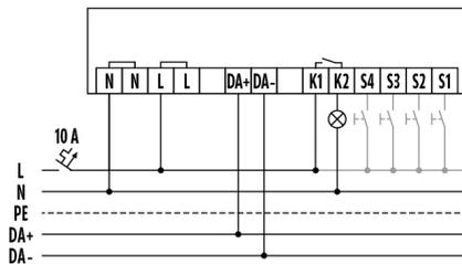
Raccordement avec commande optionnelle par poussoirs.
