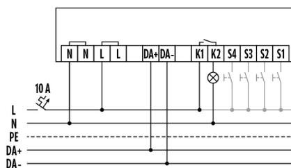
Raccordement avec commande optionnelle par poussoirs.
