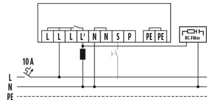
Raccordement d'inductances (par ex. relais, contacteur, ballast) peut nécessiter l'insertion d'un filtre RC (RC-Filter).
