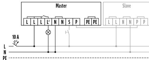
Raccordement maître/esclave avec commande optionnelle par poussoir. Un appareil maître peut être raccordé à 10 appareils esclaves au maximum
