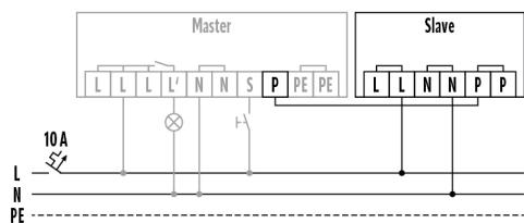
Raccordement maître/esclave. Un appareil maître peut être raccordé à 10 appareils esclaves au maximum.
