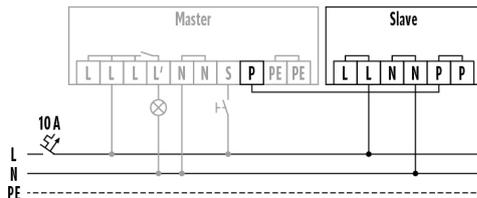
Raccordement maître/esclave. Un appareil maître peut être raccordé à 10 appareils esclaves au maximum.
