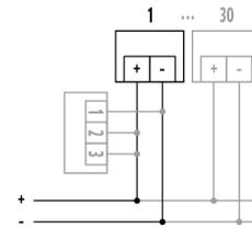
Alimentation sur pile 9 V. Option possible : mise en réseau de 30 détecteurs max. / relais PROTECTOR K (max. 300 m de câblage)
