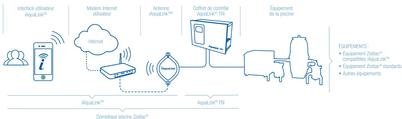
La domotique piscine est le **pilotage à distance** de tous les équipements de la piscine (filtration, traitement de l'eau, chauffage, éclairage, nettoyage, animations d'eau...). Le boîtier de commande devient l'élément central de la piscine qui assure la connexion entre ses différents équipements.
