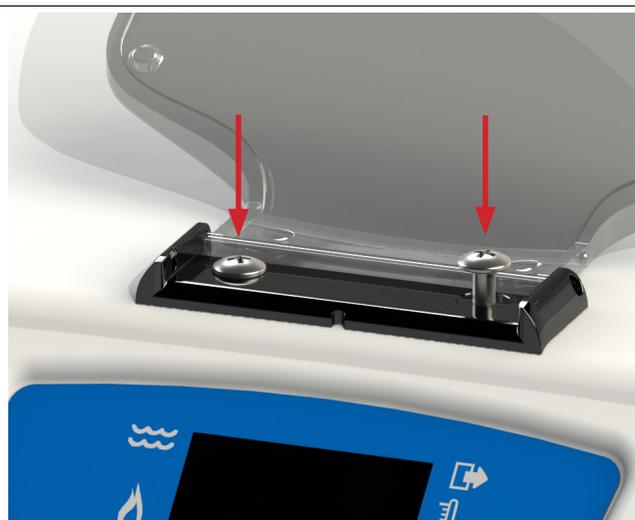
Maintenir la base du clapet, soulever la visière et visser la base à l'aide des 2 vis fournies. Arrêter le serrage des vis lorsque la tête de vis est au contact de la base.
