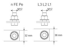
Capacité de raccordement de la borne Type 3 - Vide
