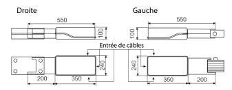
Les blocs d'alimentation de 160 et 250 A sont équipées de bornes pour des câbles allant jusqu'à 150mm<sup>2</sup>; pour des intensités plus élevées, la connexion des câbles au bloc d'alimentation nécessite des cosses de câble à fixer sur les répartiteurs fournis.
