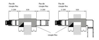
Après installation, boucher tous les interstices avec un matériau conforme aux réglementations en vigueur pour la classe de résistance
