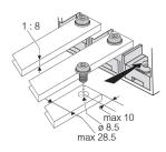
Capacité de raccordement de la borne Type 2 – Avec porte-fusibles  $L3\ L2\ L1\ N\ FE\ Pe$
