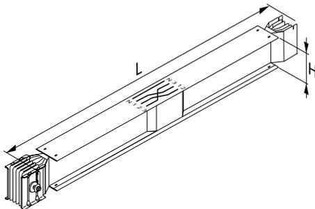
En cas d'utilisation de sections supérieures à 100 mètres (100 000 mm), il est recommandé d'installer deux éléments de transposition de phase (l'un à 1/3 de la longueur et l'autre aux 2/3), afin d'équilibrer l'impédance électrique du système..
