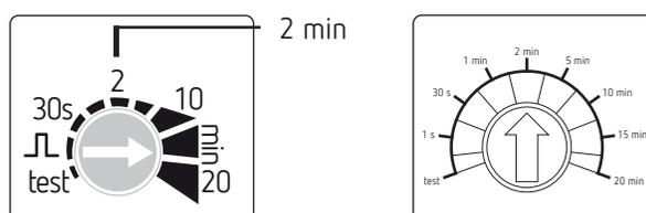
Pour utiliser la fonction d'impulsion (par ex. pour une minuterie d'escalier)
