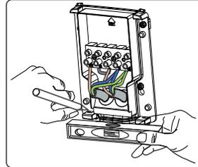
► Reporter les marquages pour les trous au mur (avec le gabarit de perçage / socle joint).
