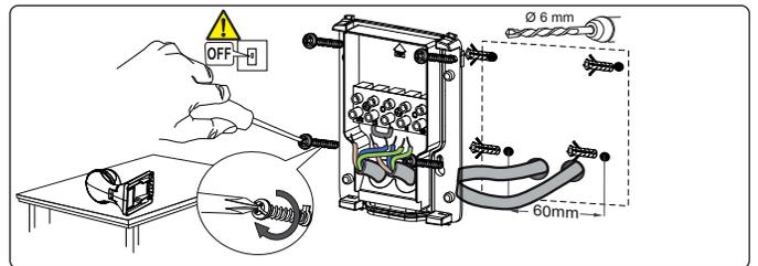
► Faire passer le câble à travers le joint d'étanchéité du socle.
