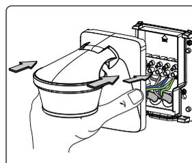
► Insérer le détecteur de mouvement sur le socle et l'enclencher.
