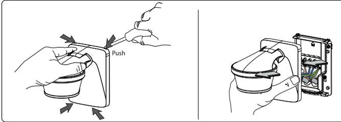
➤ Détacher doucement les crochets d'enclenchement supérieur et inférieur avec le tournevis et retirer l'appareil par l'avant.
