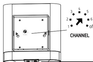
Potentiomètre pour régler le canal radio pour le regroupement d'appareils (sur la face arrière de l'appareil)
