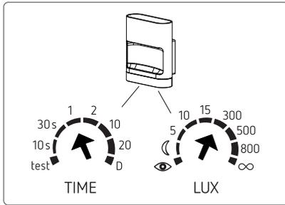
① Si la valeur réglée sur un potentiomètre est modifiée, les valeurs des deux potentiomètres (pour la luminosité et la durée) sont reprises, indépendamment des réglages dans l'application ou sur theSenda P.
