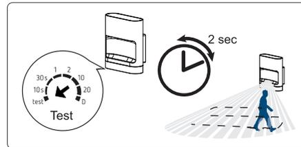
① Le test déambulatoire peut également être activé dans l'application (Instructions de commande → Test de présence) ou avec theSenda P.
