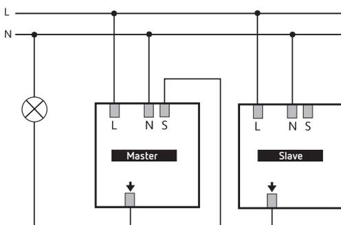
Si la zone de détection couverte par un seul détecteur de mouvement ne suffit pas (dans les grandes pièces), il est possible de procéder à un montage en parallèle de plusieurs détecteurs en reliant les bornes S et ↓.
