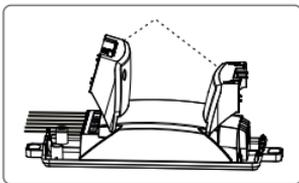
➤ Raccorder le bloc d'alimentation et la partie de capteur conformément au schéma de connexion
