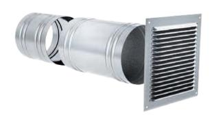
L'ensemble constitué du manchon fixe de longueur 250 mm et du manchon de réglage de longueur 200 mm permet d'assurer la traversée de murs d'épaisseurs 250 à 400 mm.
