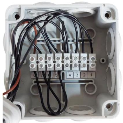
Fig. 8.2 Bornier du boîtier de commande câblé.
