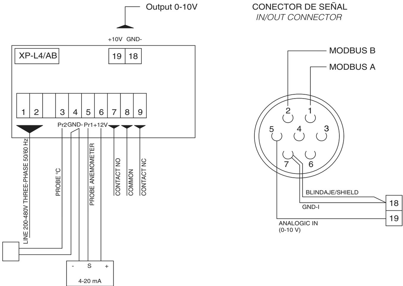
NOTA: Hay que llevar los cables A y B al tablero a la altura de la cabeza para la conexión Modbus para mantenimiento y diagnóstico
