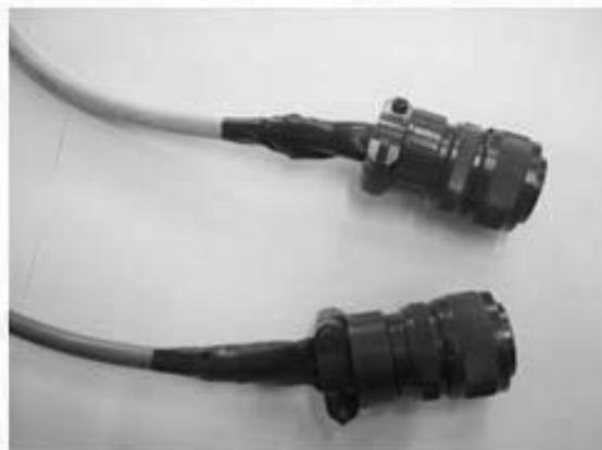
*HAY QUE PROTEGER LA PARTE TRASERA DE LOS CONECTORES DE CUALQUIER INFILTRACIÓN DE HUMEDAD Y/O SUCIEDAD POR MEDIO DE CINTA AISLANTE O TUBO TERMORRESTRINGIBLE*
