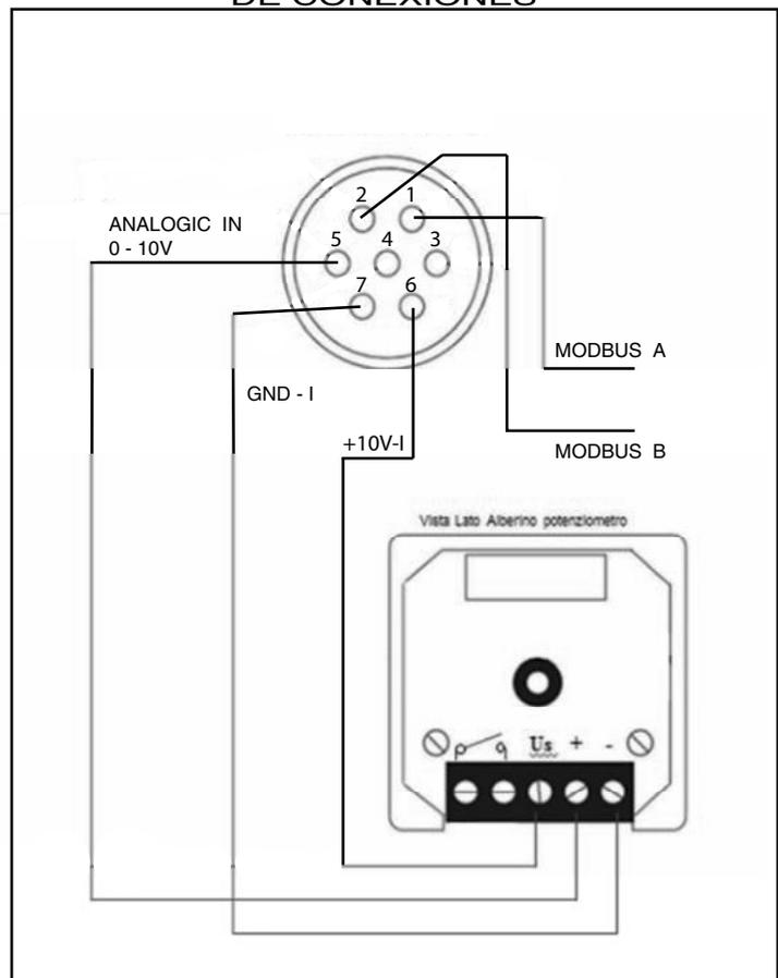
NOTA: Hay que llevar los cables A y B al tablero a la altura de la cabeza para la conexión Modbus para mantenimiento y diagnóstico
