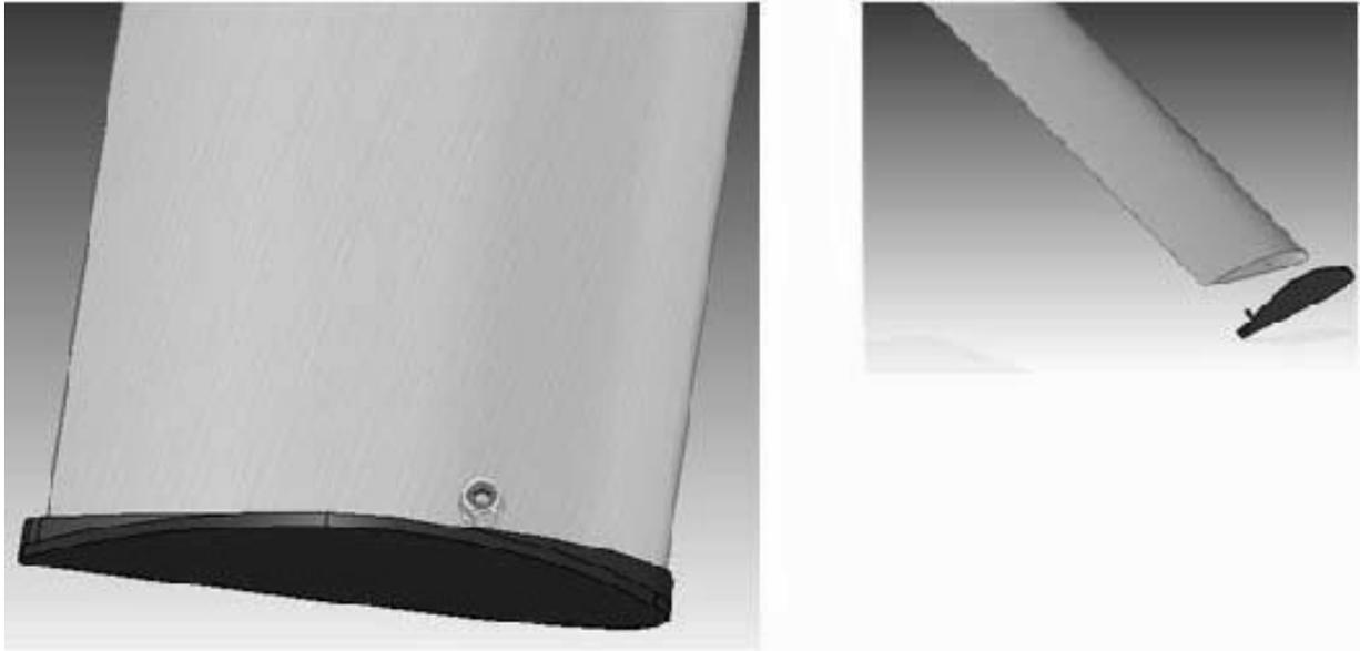
*Desenrosque el tornillo que fija el terminal de plástico a la pala*
