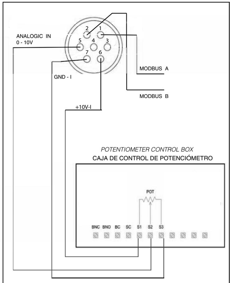
NOTA: Hay que llevar los cables A y B al tablero a la altura de la cabeza para la conexión Modbus para mantenimiento y diagnóstico
