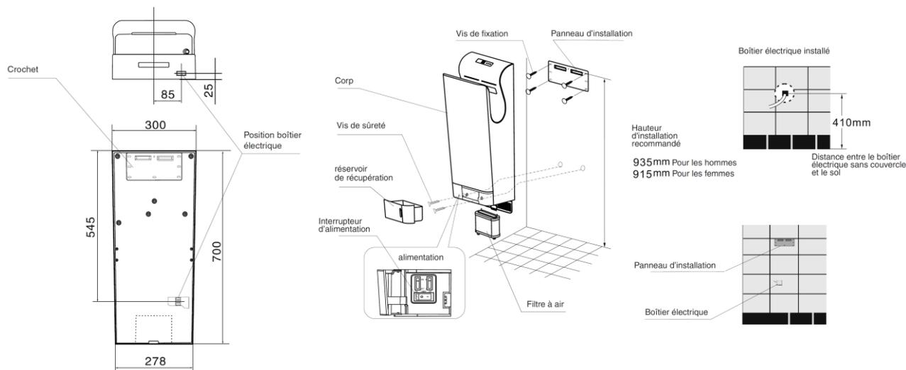
**Attention à respecter les distances minimums entre l'appareil et son environnement soit environ 150 mm du sol et 150 mm de champs libre sur les côtés. Attention à ne pas installer l'appareil derrière une porte ou dans un passage (risque de collision).**
