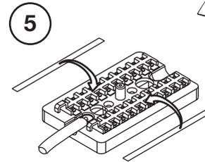
5 Incollare le etichette fornite a corredo con l'indicazione dei morsetti a seconda del sistema nel quale si utilizza il supporto.
