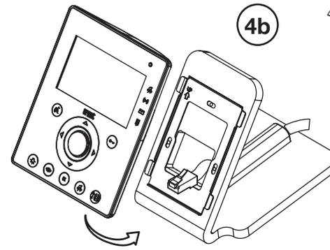
Per i videocitofoni Aiko del sistema Ipervice collegare il cavo di sistema 1039/90 direttamente al videocitofono senza utilizzare la borchia fornita a corredo.
