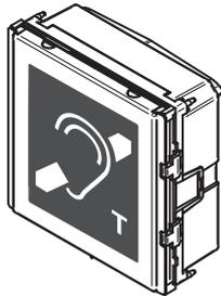
Il modulo con bobina ILA (Induction Loop Antenna) Sch. 1158/48 è un modulo che permette agli utenti con problemi di udito di ascoltare la conversazione audio sul posto esterno tramite il proprio apparecchio acustico. L'apparecchio acustico deve essere dotato di interfaccia magnetica di tipo "T".
