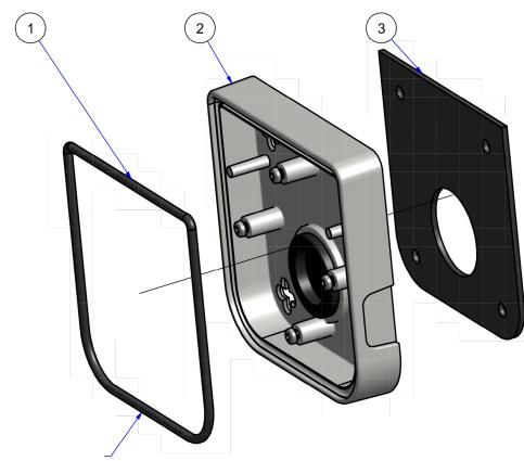
Pour une bonne étanchéité, la jonction doit impérativement se trouver en bas.
