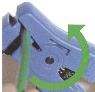
2. Tourner le dénudeur dans le sens indiqué par la flèche jusqu'à ...
