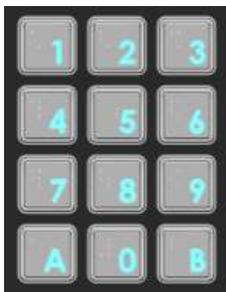
Si la programmation a été prévue, il est possible de taper un code d'ouverture porte à l'aide du clavier précédé de la touche A.
