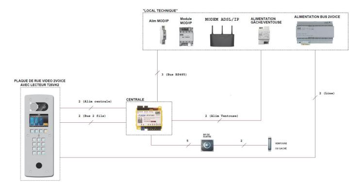
Distance maximum entre MOD/IP et modem/routeur ADSL (liaison RJ45) : 80 mètres Distance maximum entre centrale et MOD/IP (liaison RS485): 800 mètres
