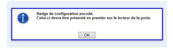
Le 1<sup>er</sup> badge à encoder correspond au badge de configuration. Il doit être obligatoirement présenté en premier sur la centrale pour permettre la configuration de la centrale.
