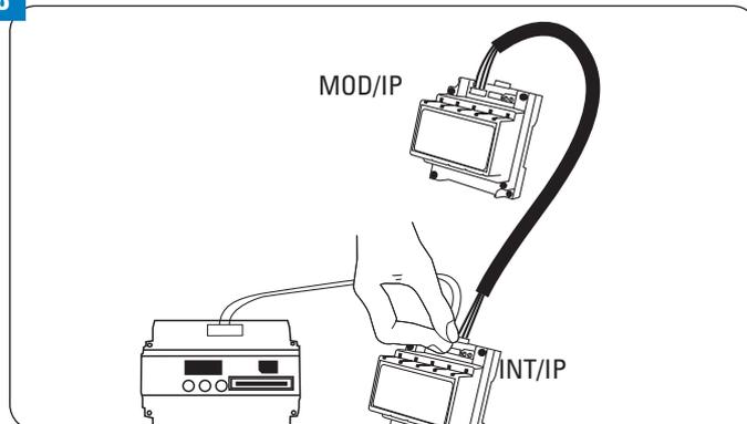
**9** Connectez le modem/routeur au MOD/IP
