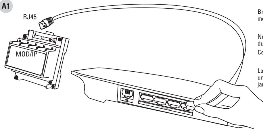
Branchez le MOD/IP à la sortie arrière N°1 du modem/routeur
