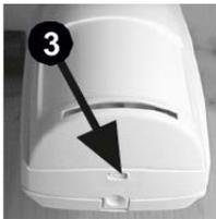
Ouvrir le détecteur de mouvements conformément à la photo. Pour cela, dévisser la fermeture du boîtier (3) à l'aide d'un tournevis.
