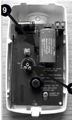
Pour activer le test de marche, reliez les deux broches de raccordement indiquées sur la photo (9) à l'aide du cavalier joint.
