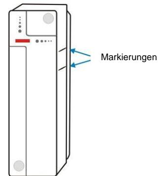
Schritt 2: Der Kontakt weist auf einer Seite 2 Markierungen auf, die die Position des Magneten angeben. Der Kontakt kann gerade oder umgekehrt installiert werden, um zu garantieren, dass die Markierungen mit dem Magneten ausgerichtet sind.
