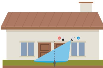
**i** La caméra est limitée par la technologie de détection PIR et peut ne pas détecter les mouvements lorsque la température ambiante est proche de celle du corps humain ou lorsque quelqu'un s'approche du capteur PIR à la verticale.
